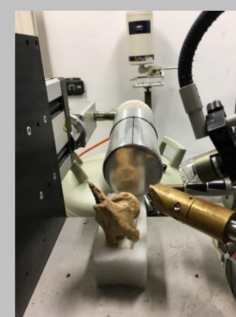
Piattaforma PIXE-PIGE, Atomki, a Debrecen, Ungheria
