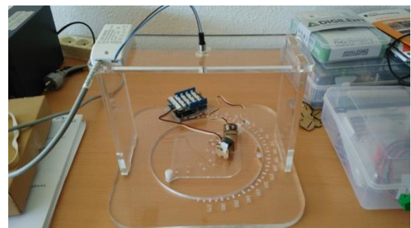
Figure 4. Dispositif expérimental pour l'apprentissage de méthodes d'estimation de cap à partir de la lumière polarisée. Le plateau est tourné manuellement. Les
