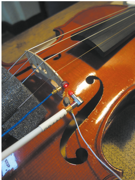
Fig. 4. Marteau d'impact et accéléromètre permettant la mesure d'une mobilité au chevalet
