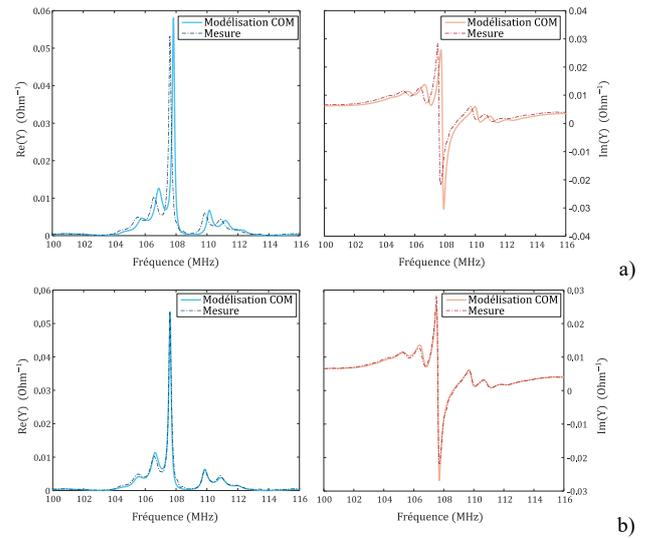
**Figure 4.** Courbes de conductance (à gauche) et de susceptance (à droite) d'un résonateur une porte synchrone avant (a) et après (b) l'ajustage des paramètres COM. Les courbes théoriques sont présentées par les lignes épaisses et les mesures sont présentées par les lignes étroites. Les paramètres COM issus de la procédure d'ajustage ont été utilisés pour les calculs
