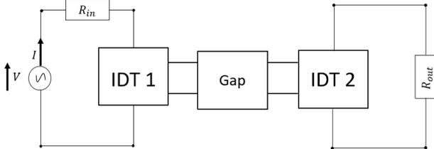
**Figure 5.** Structure en cascade d'une ligne à retard
