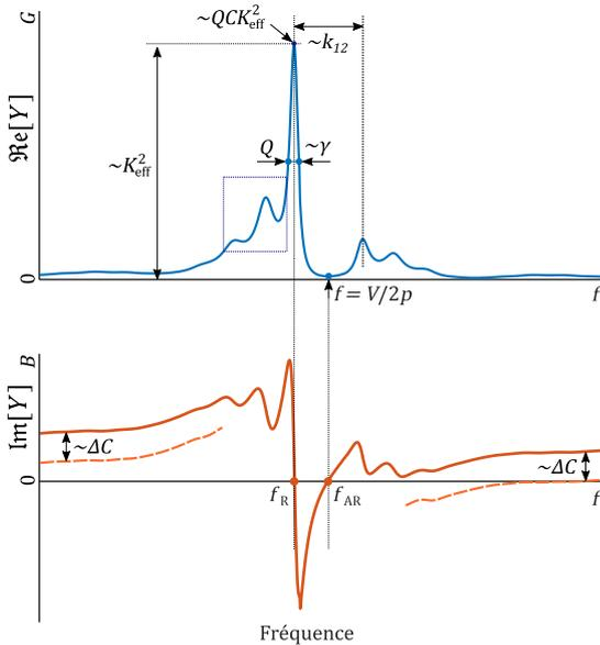
**Figure 3.** Dépendance des caractéristiques de courbes de conductance (G) et de susceptance (B) d'un résonateur 1-porte synchrone de différents paramètres COM
