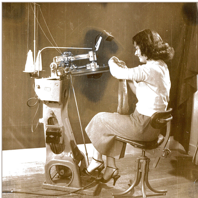
Figure 3 - Démonstration d'une monitrice sur une machine remailage tricot, [années 1960-1970]
