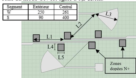
Figure 1. Vue d'ensemble du filtre sur HFSS<sup>TM</sup> et dimensions des lignes couplées ( $\mu\text{m}$ )
