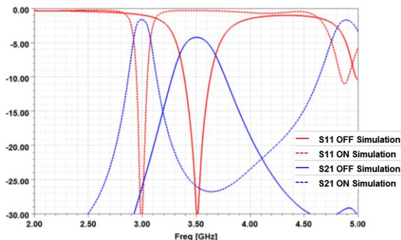
Figure 5. Réponse en paramètres S simulée.
