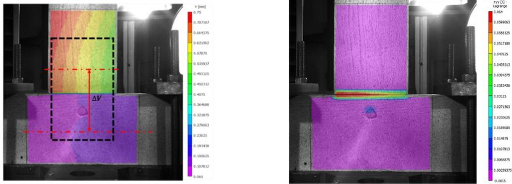
**FIGURE 8.** Champs cinématiques obtenus après 6 minutes d’essai : champ de déplacement vertical (à gauche) et champ de déformation verticale (à droite)
