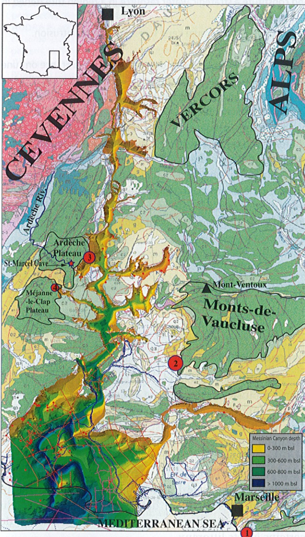
Figure 1 : 3D view of the buried part of the Rhône and Durance Messinian Canyons in the south of France. This view is superimposed on the French Geological map (millionth map). Main karstic areas (Urgonian limestones) are surrounded by black line. Main deep flooded karsts springs are located by a red circle (1: Port-Miou Spring, 2: Fontaine de Vaucluse Spring, 3 & 4: Goul de la Tannerie spring and Goul du Pont Spring, 5: Marnade Spring; from Roure et al., 2009, modified). Restitution 3D de la partie enfouie du canyon messinien du Rhône dans le Sud-Est de la France. Cette restitution est superposée sur le fond géologique au millionième. Les principaux massifs karstiques (calcaires urgoniens du Crétacé inf.) sont entourés en noir. Les principales émergences des karsts noyés profonds sont localisées par un cercle rouge (1 : source sous-marine de Port-Miou, 2 : Fontaine de Vaucluse, 3 & 4 : émergences des Goul de la Tannerie et Goul du Pont, 5 : source de la Marnade ; d'après Roure et al., 2009, modifié).
