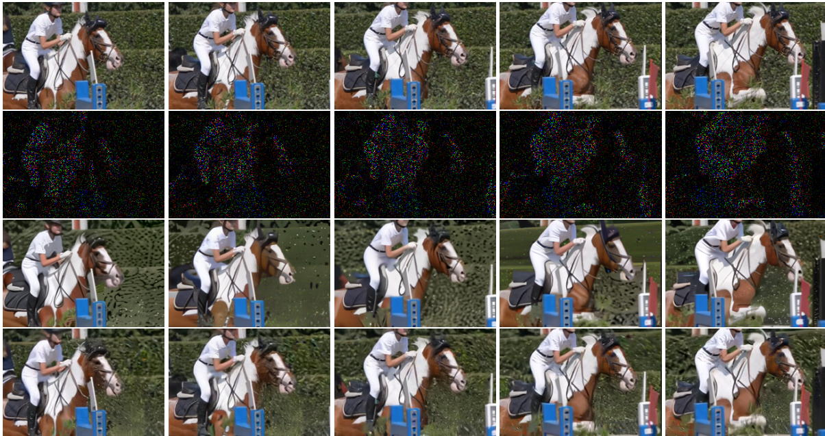
FIGURE 1 – Interpolation ( \rho = 0.9 ) après 500 itérations de PnP-ADMM. 1 er rang : inconnue. 2 e rang : observation (PSNR : 7.51 dB). 3 e rang : résultat de DRUNet (25.93 dB). 4 e rang : résultat de FastDVDnet (27.30 dB). Bien que l'écart en dB sur l'ensemble de la vidéo ne soit pas extrêmement élevé, FastDVDnet produit de meilleurs résultats, temporellement plus stables.
