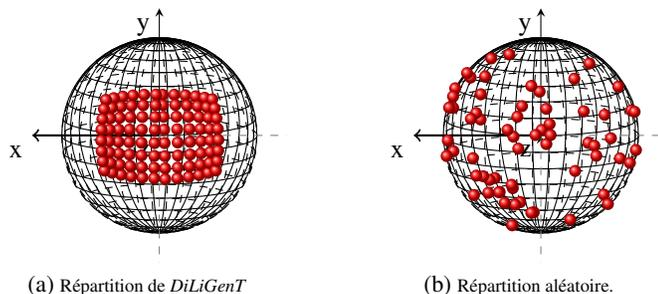
FIG. 4: Distribution des directions d’éclairage dans le jeu de données réelles *DiLiGenT*, et exemple d’une distribution aléatoire. L’axe  $z$  correspond à l’axe optique de l’appareil photographique, l’objet imagé se situant aux coordonnées  $(0, 0, 0)$ .
