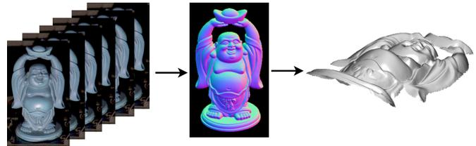
FIG. 1: Principe de la stéréophotométrie. À partir d'un ensemble d'images prises sous des directions d'éclairage différentes (à gauche), une carte de normales peut être estimée (au centre), de laquelle on peut déduire une carte de profondeur par intégration. Dans ce travail nous nous intéressons à l'amélioration des techniques neuronales pour l'estimation des normales.
