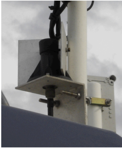
Figure 16 : Antennes Wifi et réflecteurs installés sur le Barcarin V et au niveau de la maison du Passeur
