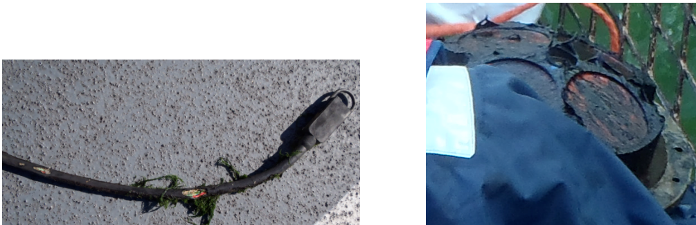
Figure 11 : Etat du câble Adcp et des faisceaux de l'Adcp après 175 jours de fonctionnement
