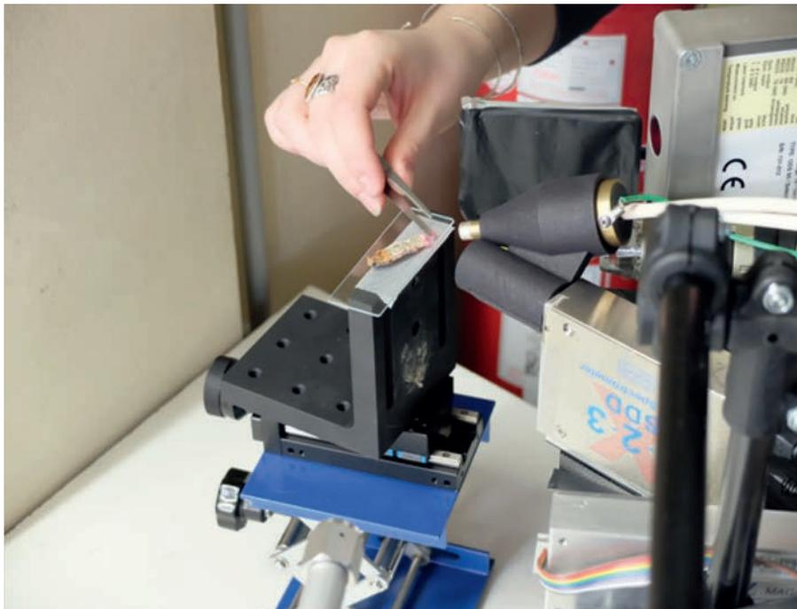
*Fig. 1 - Positionnement du collyre stratiotion pour analyse par diffraction X et fluorescence X
