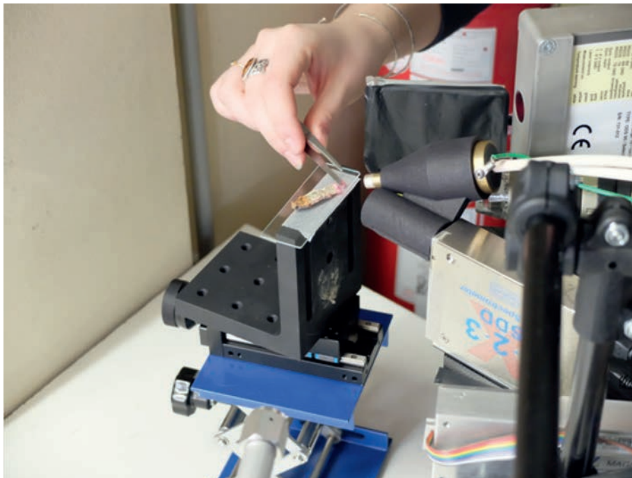
Fig. 1 - Positionnement du collyre stratiotion pour analyse par diffraction X et fluorescence X [© Ludovic Bellot-Gurlet, MONARIS].
