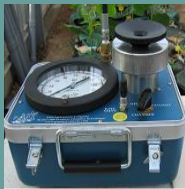
Chambre à pression pour mesurer le potentiel hydrique sur tige ou feuille
