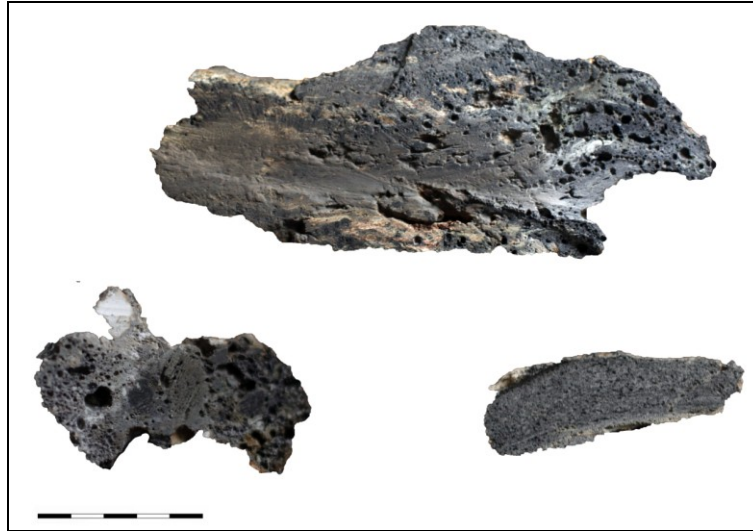
Fig. 61 : photo macroscopique de section de scories. On distingue clairement les différentes phases constituantes et les restes important de gangue minérale.
