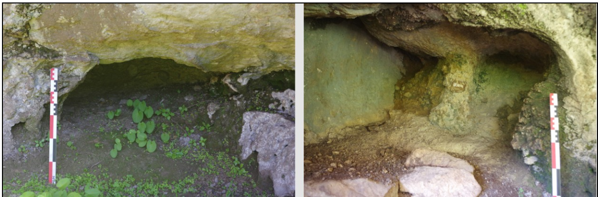
Fig. 21 : Vue de détail des alvéoles d'abattage suivant le filon N-S (à gauche) et les deux filon O-E (à droite).
