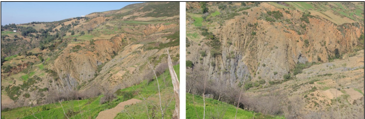
Fig. 17 : vues générale et de détail de la mine moderne O-E-M-7. Les haldes correspondent au cônes de déjection en gris.
