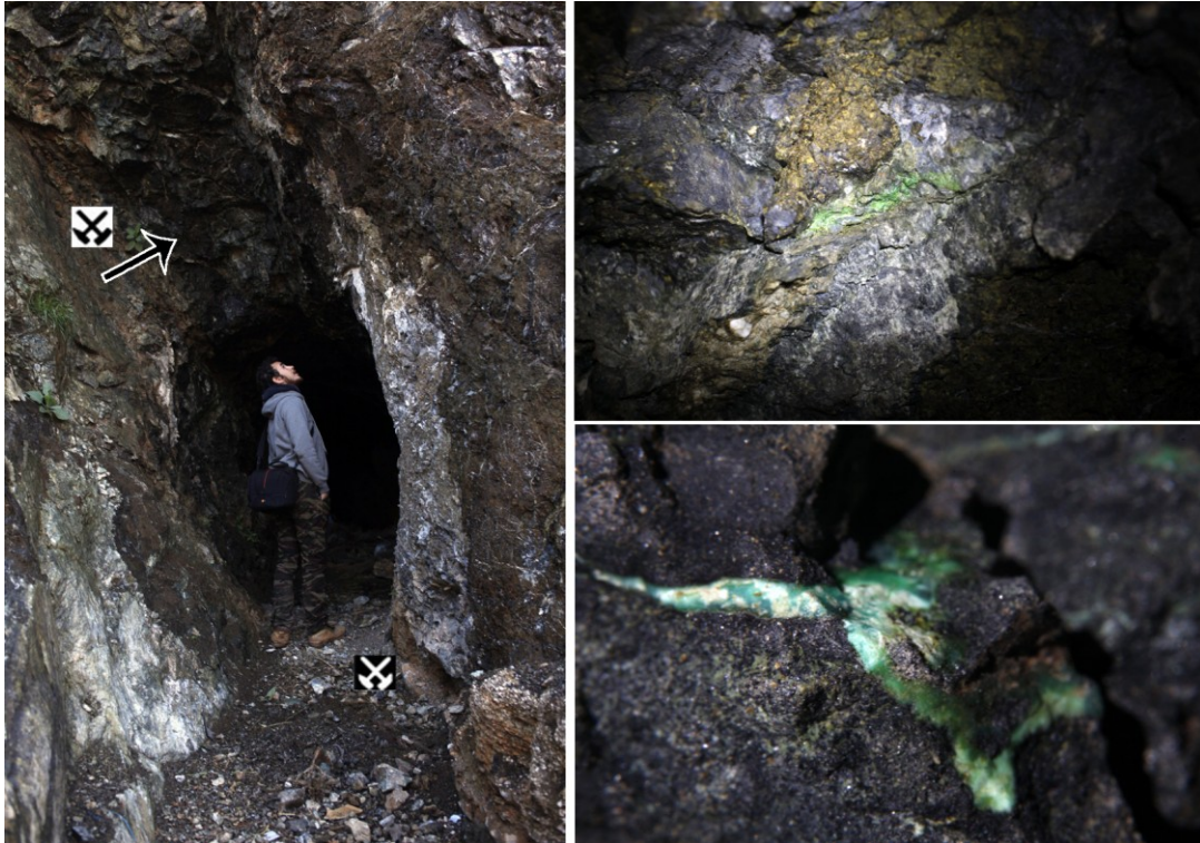
Fig. 44 : Vue de la galerie inférieure du site O-J-N-M-2 (photo de gauche). Au dessus de la galerie creusée à l'époque du protectorat espagnol, les traces d'une extraction plus ancienne (symbole mine sur fond blanc). Vue du filon de cuivre d'une puissance de 50 cm (photo en haut à droite), vue de détail de la minéralisation de cuivre (malachite) dans un échantillon de minerais (photo en bas à droite).
