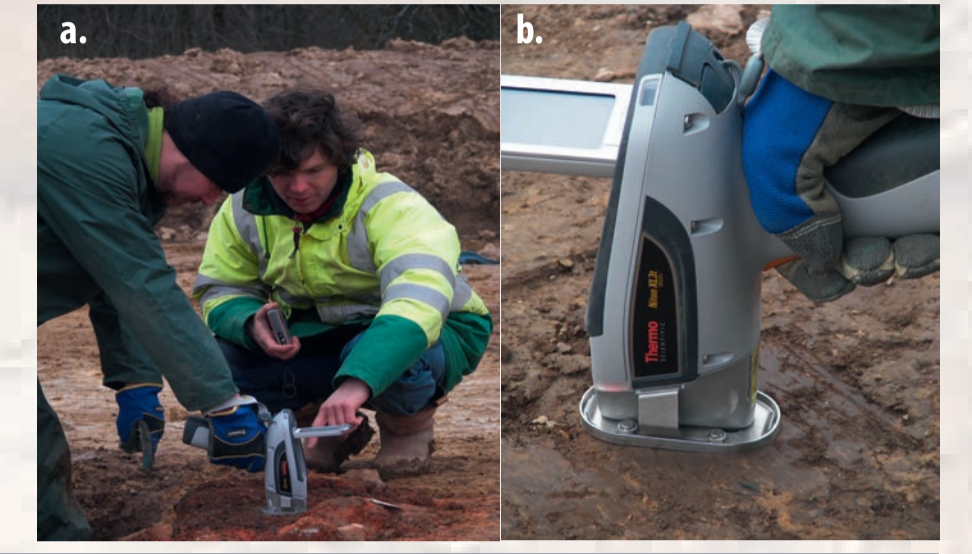
Fig 3: Réalisation des analyses XRF in-situ (a et b) L'analyseur de fluorescence X portable utilisé (Niton XL3t GOLDD+) équipé de son masque de protection de terrain.
