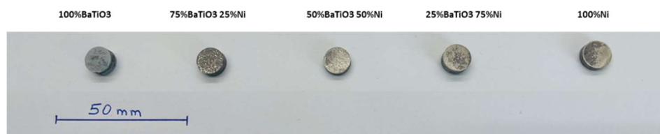
Figure 3 : échantillons obtenus par SPS avec différentes proportions de mélange
