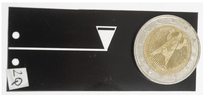
FIGURE 2. Photographie de l'antenne réalisée par sérigraphie.
