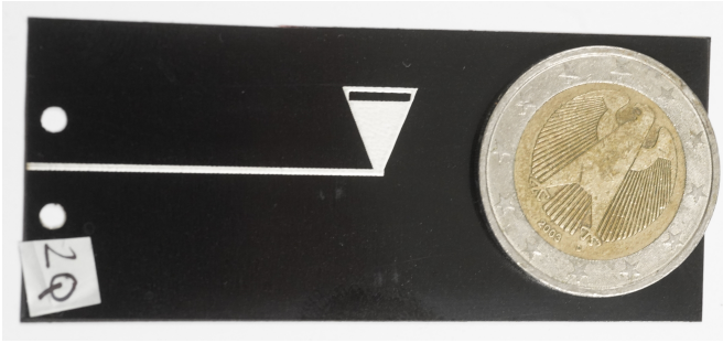
Figure 2. Photographie de l'antenne réalisée par sérigraphie.
