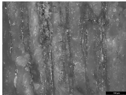
Coupes longitudinales radiale et tangentielle: rayons fins ; existence de faux rayons?
