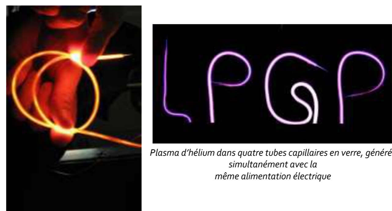
Plasma d'hélium créé dans un tube capillaire souple en polymère, avec jet en sortie.
