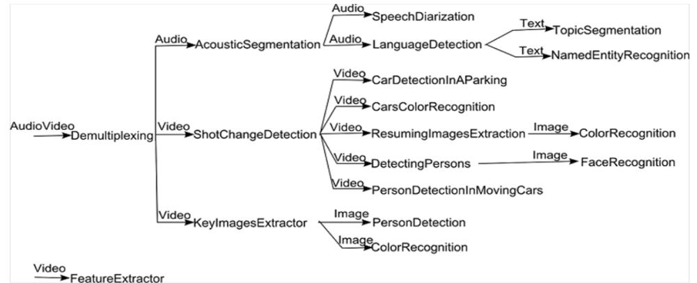
FIGURE 2: Graphe de chaînes d'application d'algorithmes d'indexation.
