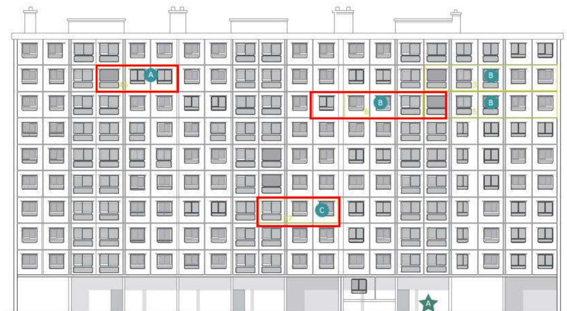
Repérage des capteurs du diagnostic thermique d'été
