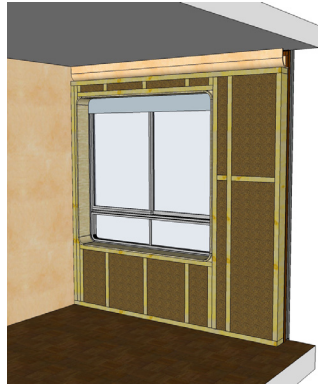
Pose de l'isolant et du frein vapeur du prototype 1 © Mathilde Padilla, 25 janvier 2020
