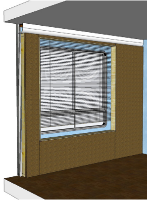
Pose de la deuxième couche d'isolant fibre de bois © Mathilde Padilla, 25 janvier 2020
