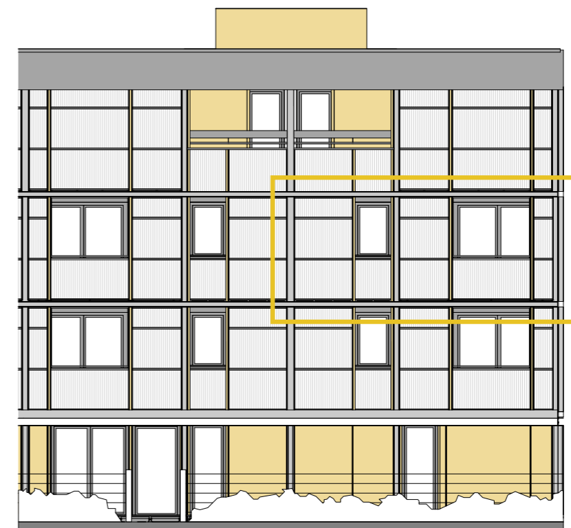
Figure 3 : Les Tilleuls Localisation de l'emprise du prototype sur une travée de façade.
