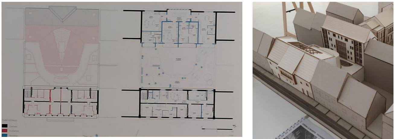
BEUZIT Yann, PAPIN Maxime, RAMAGE Will, YAOUANQ Rémi : projet sur le cinéma Majestic : le cinéma et les intérieurs sont très détruits mais la logique d'implantation et les façades principales sont conservées.
