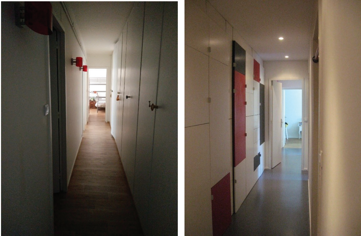
Figure 8. Corridor fonctionnel avec rangements sur toute la longueur et pièces de services (WC, salle de bain). Résidence Pontet Lamartine
