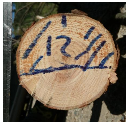
Fig. 2 : Photo d'une section de branche. La surface hachurée représente la partie sciée. La partie inférieure représente la portion résiduelle de section au moment de la rupture.
