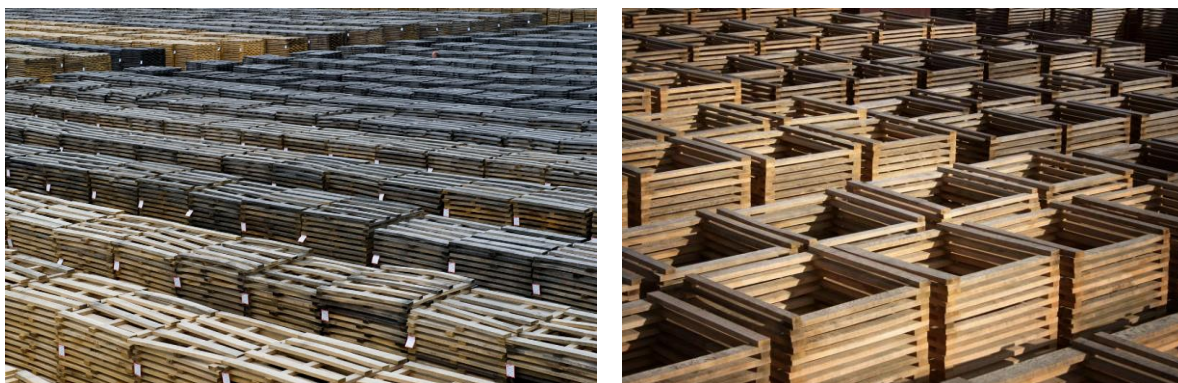
Fig. 2 & 3 : empilement des merrains selon la méthode bordelaise (g) 2 et bourguignonne (d) 3
