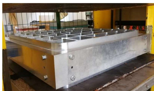
Fig. 5 : Moule aluminium en cours d'utilisation dans la presse
