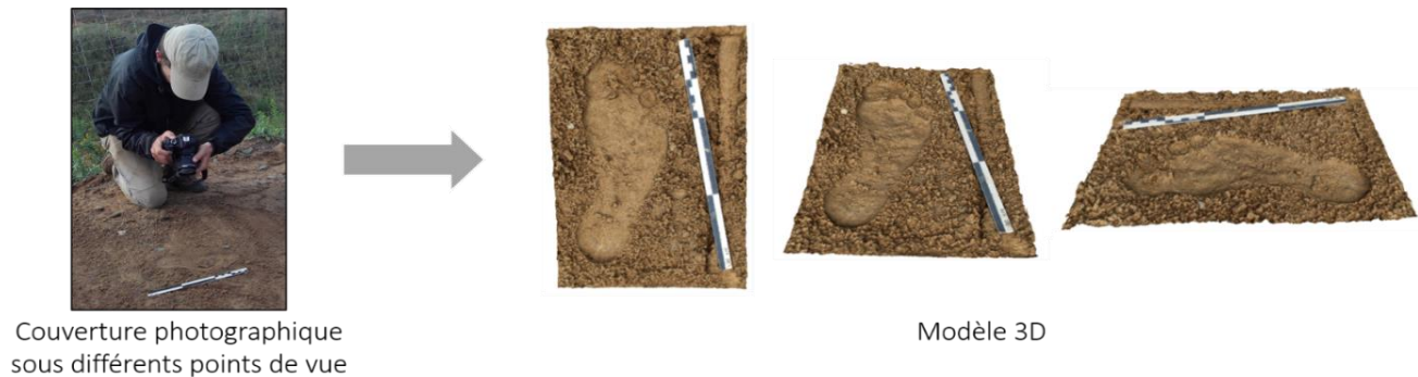
Fig. 5. Modélisation en 3D d'une empreinte de pied par photogrammétrie.
