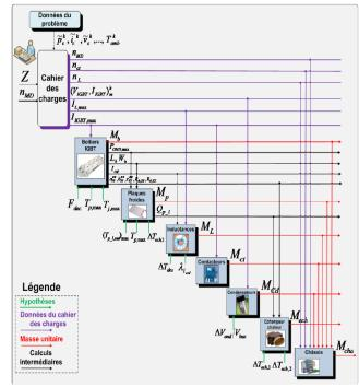
Figure 15 power center dimensionning optimisation framework
