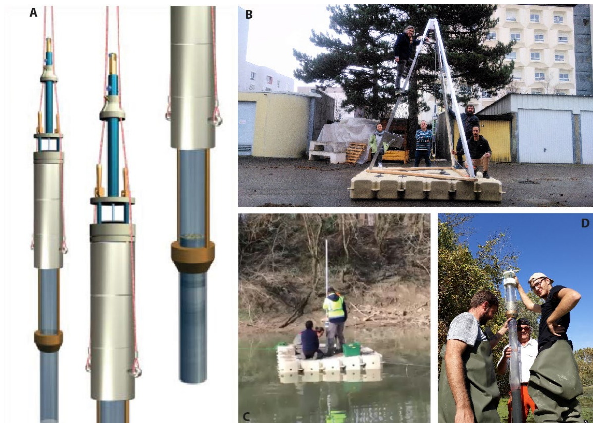
Figure 3 : a. principe du carottier UWITEC ; b. plateforme de carottage avec trépied et carottier utilisée pour l'extraction des carottes ; c. extraction d'une carotte à Pierre Bénite (Site de Ciselande) et D/ Carotte prélevée à Péage de Roussillon (Site de l'Ilon)
