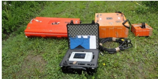
Figure 5: SIR-3000 au premier plan, et de gauche à droite antennes de 100, 200 et 400 MHz.
