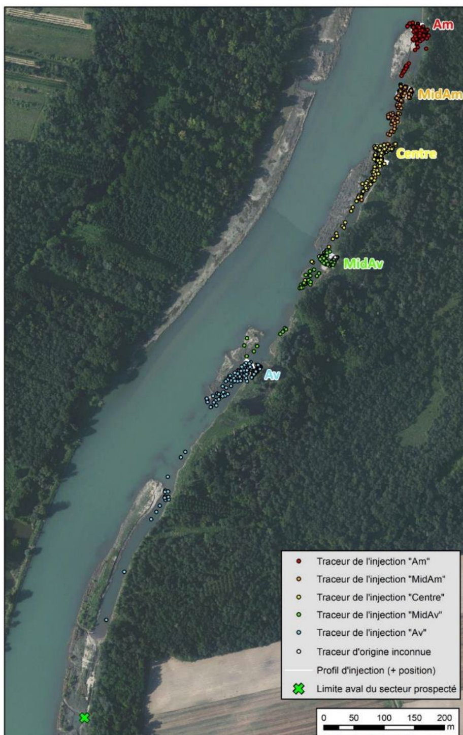
Figure 23. L'Île des Gravieres : localisation des traceurs pour le relevé S3
