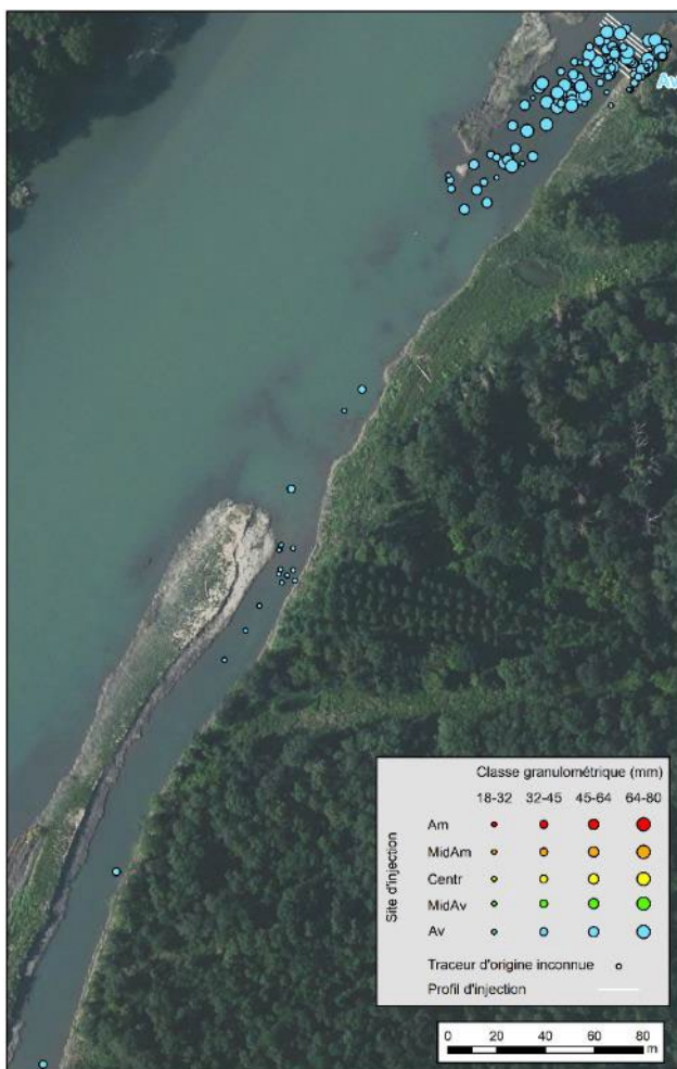
Figure 26. L'Île des Graviers : Position et taille (axe b) des traceurs pour le relevé S3 : injection « Am » et « MidAm » (haut gauche), injections « Centr » et « MidAv » (haut droit), injection « Av » (bas gauche)
