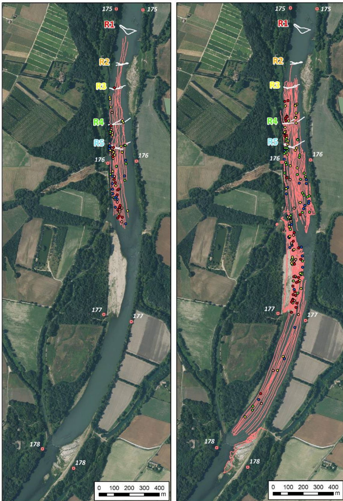
Figure 35. L'île des Dames : prospection et position des traceurs localisés pour les relevés S4 et S5 (la couleur du symbole se réfère aux zones d'injection)
