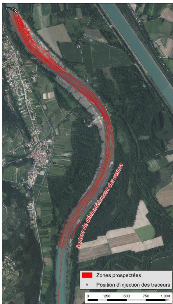
Figure 27. Réinjection sédimentaire de la Platière : localisation des sites d'injection des traceurs RFID et des zones prospectées en S3 (mars-mai 2022)
