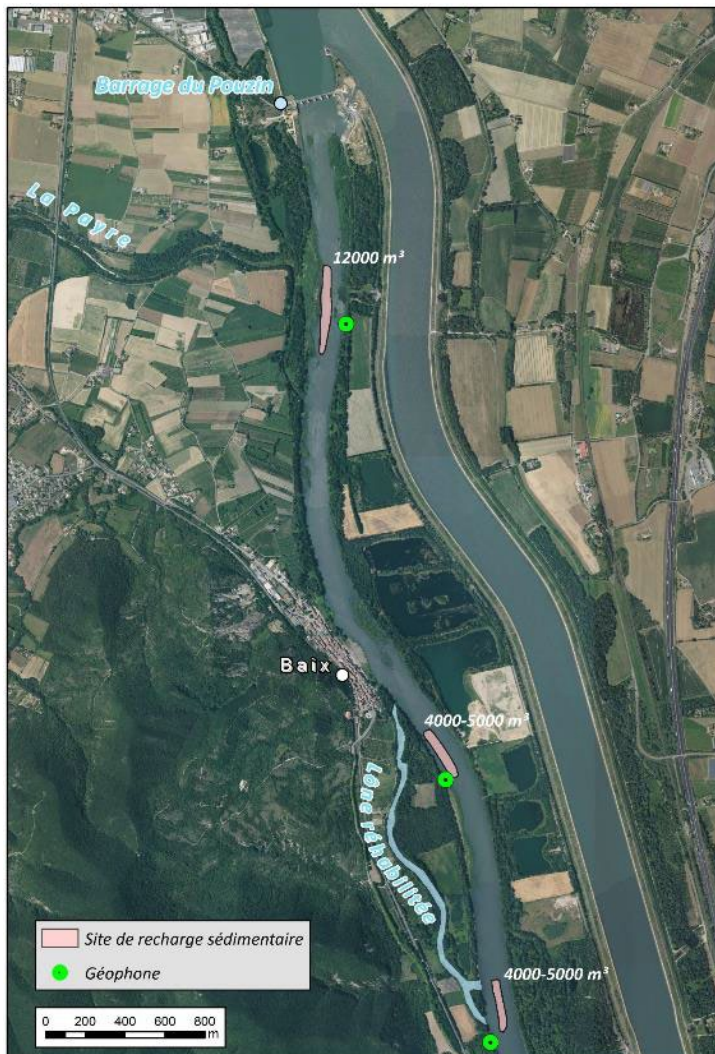
Figure 57. Le Vieux Rhône de Baix-le-Logis-Neuf : localisation des sites de réinjection sédimentaire et des stations sismiques
