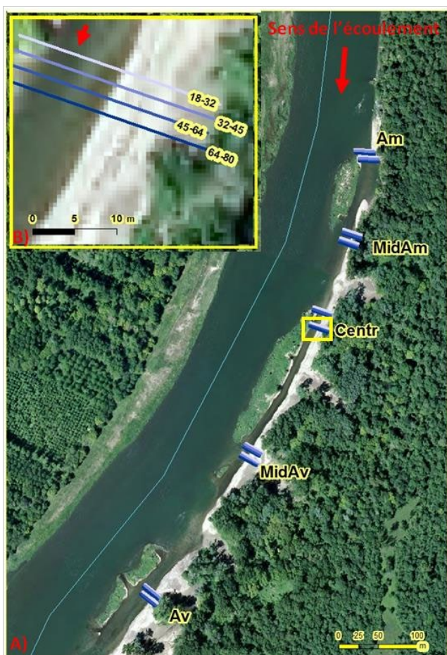
Figure 7. L'île des Gravieres : (A) localisation des sites d'injection des traceurs RFID ; (B) répartition par classes granulométriques
