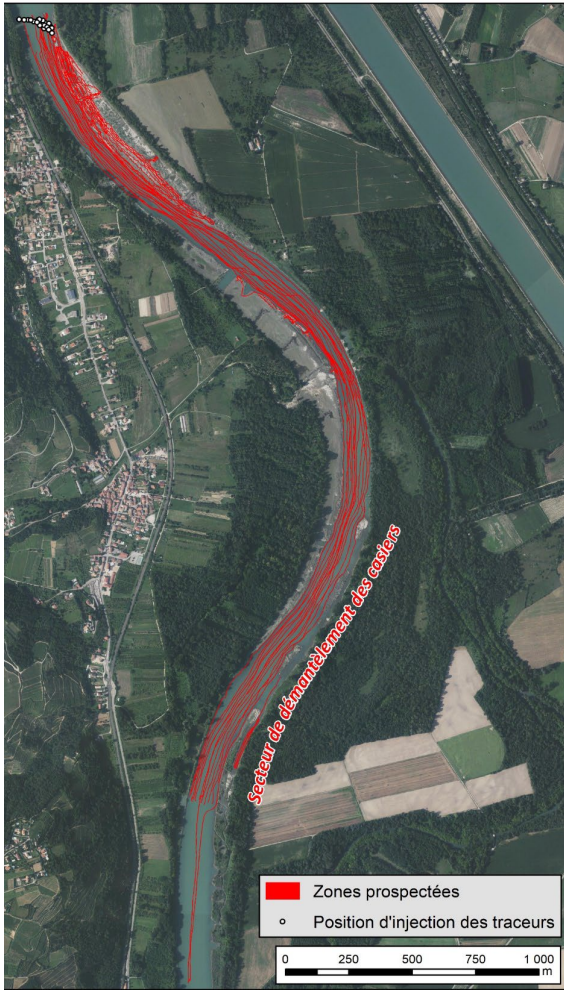
Figure 15. Recharge sédimentaire de la Platière : localisation des sites d'injection des traceurs RFID et des zones prospectées en S3 (mars-mai 2022)
