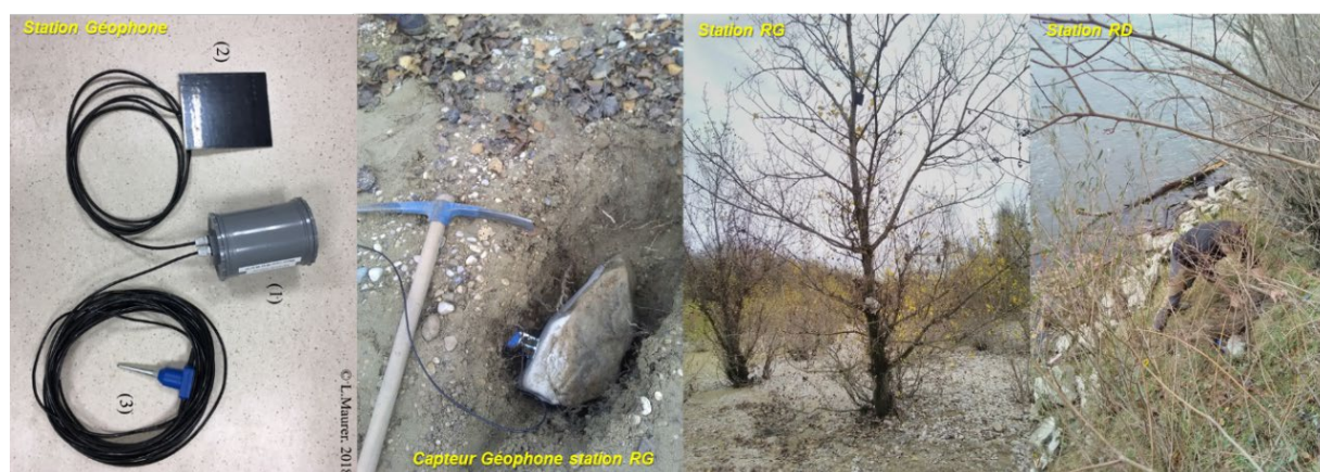
Figure 37. Le canal de Miribel : détails des composants de la station géophone (à gauche), son installation en rive gauche (au centre) et en rive droite (à droite) (Cassel et al., 2022)
