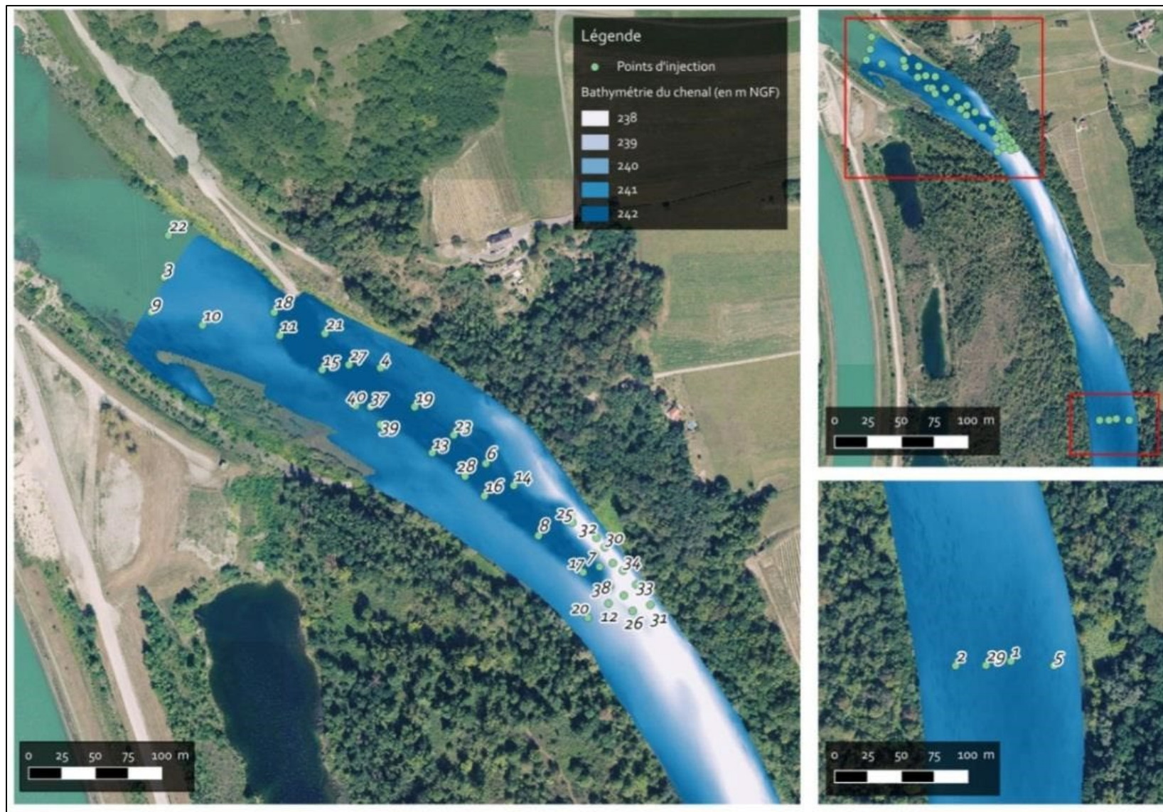
Figure 1. Recharge sédimentaire de Motz : Localisation des injections des traceurs en fonction de la bathymétrie initiale (GeoPeka, 2018)
