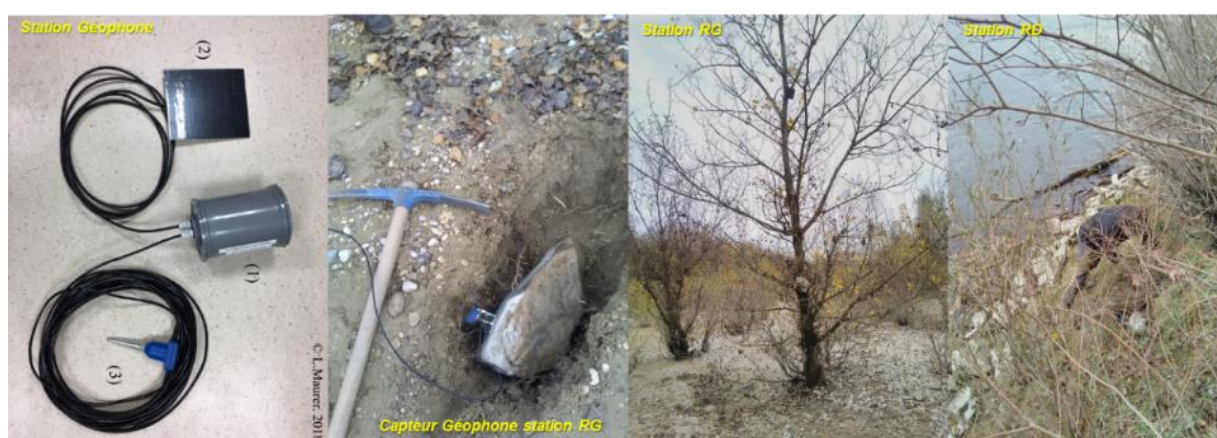
Figure 14. Le canal de Miribel : détails des composants de la station géophone (à gauche), son installation en rive gauche (au centre) et en rive droite (à droite) (Cassel et al., 2022)
