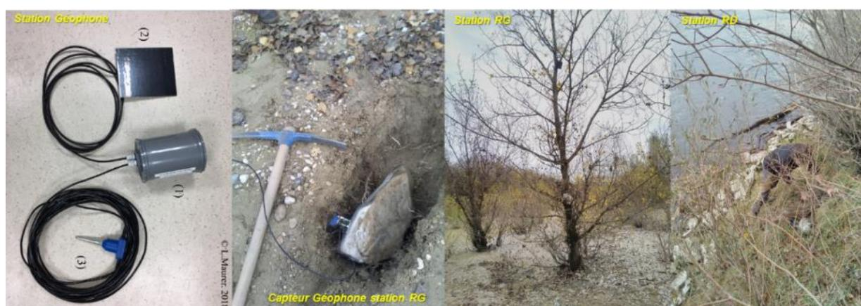
**Figure 14.** Le canal de Miribel : détails des composants de la station géophone (à gauche), son installation en rive gauche (au centre) et en rive droite (à droite) (Cassel et al., 2022)
