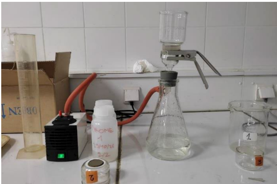
Figure 3. Matériel de filtration des MES (pompe à air, vase, support crépiné, verre gradué, filtre, éprouvette graduée).
