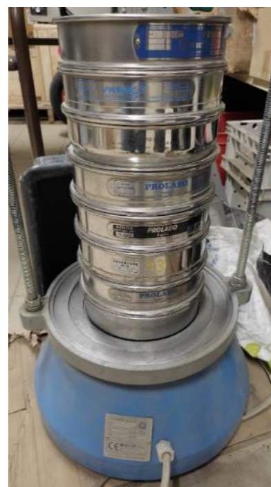
Figure 2. Analyse granulométrique en laboratoire nécessitant un tamisage à l'aide d'une colonne de tamis sur une secoueuse mécanique.
