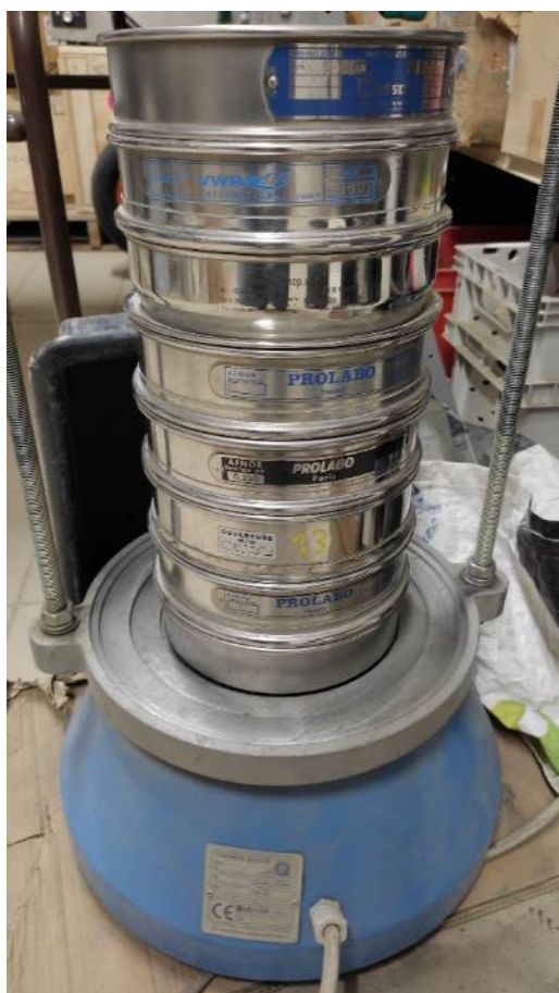
Figure 2. Analyse granulométrique en laboratoire nécessitant un tamisage à l'aide d'une colonne de tamis sur une secoueuse mécanique.
