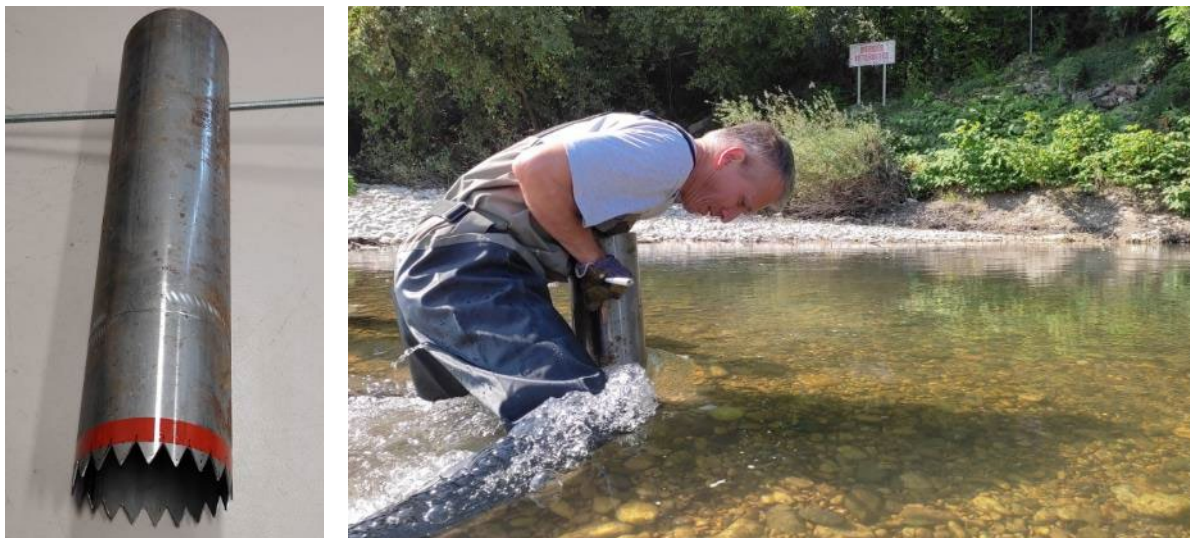
Figure 1. Echantillonneur de type « Mc Neil » ( D = 15.4 cm, H = 70 cm). Une tige métallique la traversant perpendiculairement permet son enfoncement dans le substrat par mouvements de rotation.
