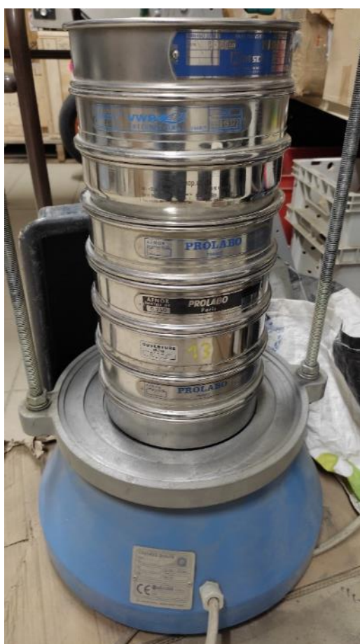
Figure 2. Analyse granulométrique en laboratoire nécessitant un tamisage à l'aide d'une colonne de tamis sur une secoueuse
