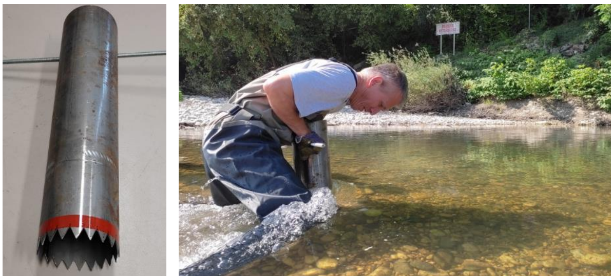
Figure 1. Echantillonneur de type « Mc Neil »
