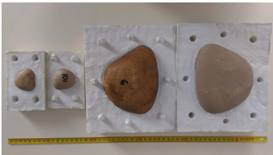
Exemple de particules artificielles conçues afin d'assurer un suivi des déplacements de la charge de fond. A gauche, le plus petit galet ayant pu être marqué (axe b = 44,5 mm, diamètre traceurs = 31 mm). A droite, le plus grand traceur marqué (axe b = 108 mm). Pour chacune des tailles, la particule naturelle est à gauche.
