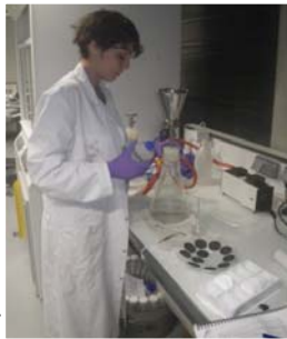
Filtration des MES
