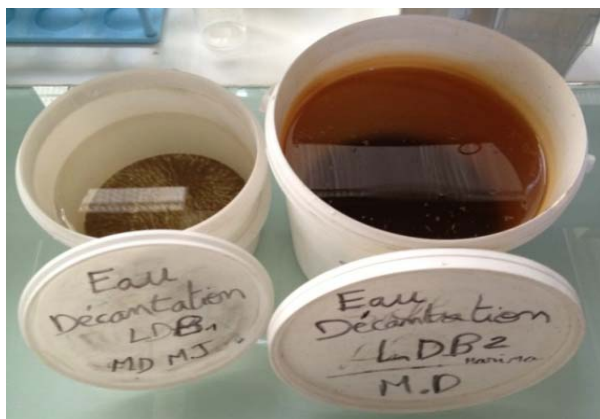
Figure 26 : Eaux de décantation de LDB1 (à gauche) et LDB2 (à droite)
