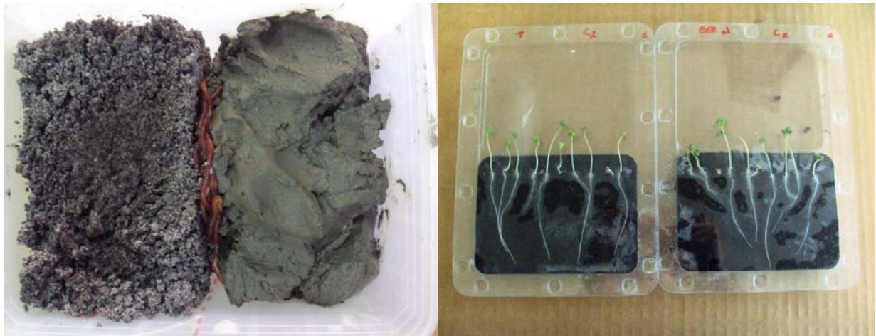
Figure 2 : A gauche : Photographie du test évitement de ver de terre (TRS à droite, sol ISO à gauche et au milieu les vers de terre) ; A droite : Photographie d'un test de germination (colza BER).
