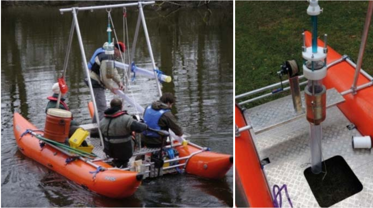
Figure 5 : Dispositif de prélèvement des carottes de sédiments couplant une embarcation de type Quadri-Raft avec ouverture centrale et un dispositif de carottage mettant en œuvre un carottier UWITEC.
