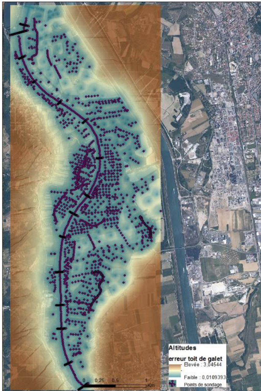
Figure 8. Erreurs (en m) associées à l'interpolation du toit de galets par cokrigage
