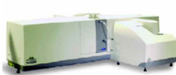
Figure 8 : Le granulomètre Mastersizer 2000 et le préparateur d'échantillon hydro 2000G.
