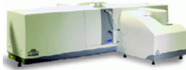
Figure 9 : Le granulomètre Mastersizer 2000 et le préparateur d'échantillon hydro 2000G.
