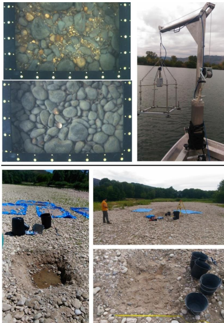
Figure 4 - Aperçu des dispositifs mis en œuvre pour la détermination de la granulométrie à partir de photographies subaquatiques (trois images du haut) et d'échantillonnages volumétriques (trois images du bas).
