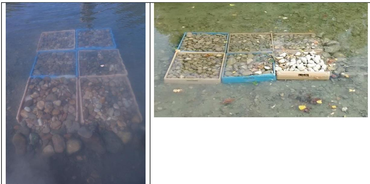
**Figure 2 : Disposition des pièges à sédiments dans le Vieux-Rhône (écoulement du bas vers le haut pour la photo de gauche, de droite à gauche pour la photo de droite).**
